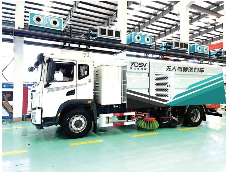
同时，此款无人驾驶环卫车还深度融合传统环卫车与互联网、人工智能等技术，从系统、硬件到软件算法全部按车规级要求正向设计，超过20款传感器整合，自研全栈式自动驾驶软件算法，通过对车道线、行人、交通标志、红绿灯、多目标障碍物识别，实现自动清扫车起步、自动泊车、障碍物避让、贴边行驶、自动换道、紧急制动、自动清扫、网联调度等功能。
