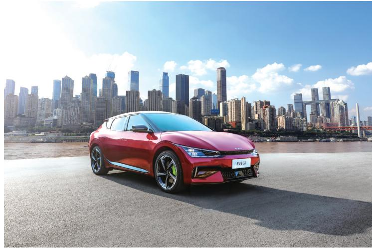
低重心、短前后悬、长轴距的设计,且电池安装在车身中央下端,让整车载荷分配科学合理,打造了卓越的转弯性能及稳定的高速行驶性能。EV6还拥有前麦弗逊式独立悬挂、后五连杆式独立悬挂设计,进一步提升了操控的平稳性和迅捷度,底盘更有韧性。同时,
