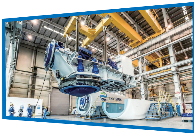
远景能源风机主机总装
