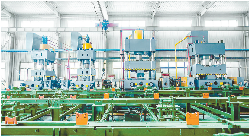
和信钻杆管端墩粗生产线。
