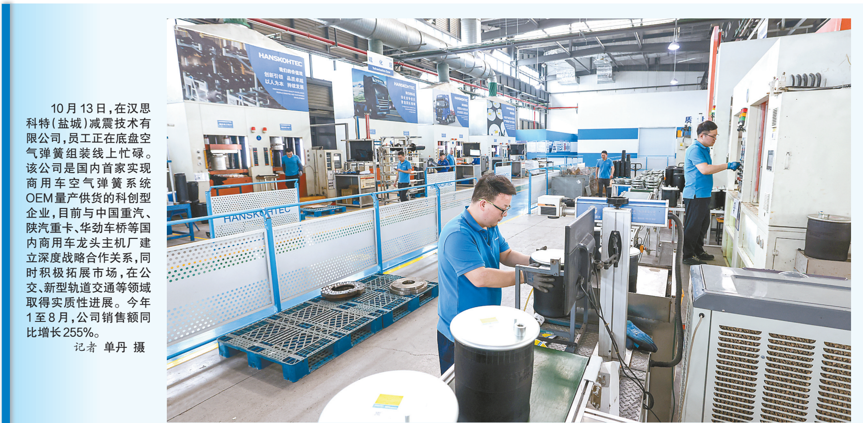
10月13日,在汉思科特(盐城)减震技术有限公司,员工正在底盘空气弹簧组装线上忙碌。该公司是国内首家实现商用车空气弹簧系统OEM量产供货的科创型企业,目前与中国重汽、陕汽重卡、华劲车桥等国内商用车龙头企业主机厂建立深度战略合作关系,同时积极拓展市场,在公交、新型轨道交通等领域取得实质性进展。今年1至8月,公司销售额同比增长255%。
