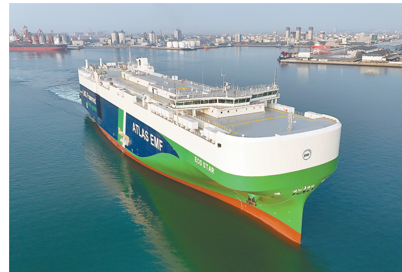
4月2日,7000车位双燃料汽车运输船“洁能之星”轮在山东港口烟台港龙口港区投入运营。该船配备液化天然气(LNG)动力系统,同时采用“氢预留”设计,可在升级改造后使用清洁的氢燃料。该运输船由中集来福士为希腊一航运公司建造,3月30日交付后抵达龙口港区。
