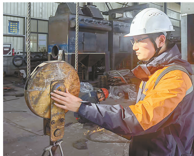
近日,省特检院盐城分院机电二室检验员在我市一家抛丸机械有限公司检验中发现起重机吊钩组滑轮罩有撞击变形现象,立即对其高限位装置进行验证,及时消除隐患、避免损失。
