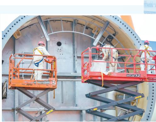
12月25日上午，位于盐城港大丰港区的江苏海恒风电设备制造有限公司内，工作人员正在安装风机塔筒内部设备。该公司根据市场需求，可生产直径8至12米、重达千吨的大型塔筒。其中，单段最长的塔筒长达41.4米，成套塔筒最长超过140米；最重的分段超过200吨，成套塔筒最重超过900吨。
