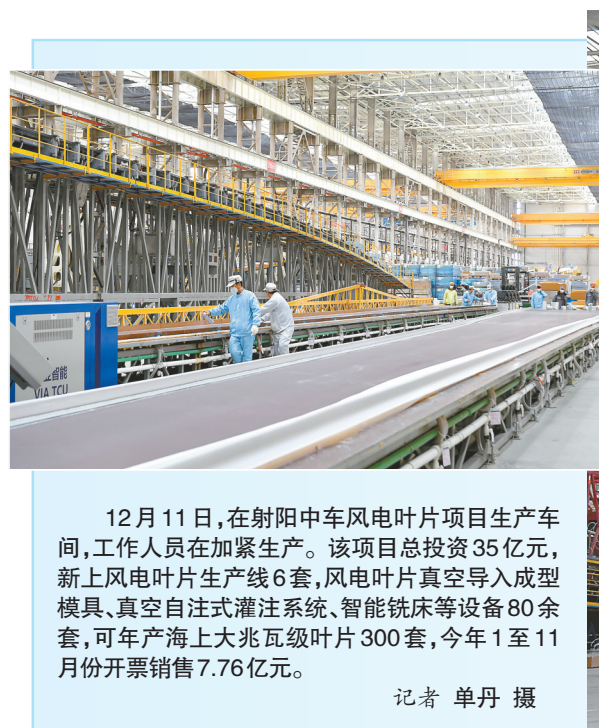
12月11日，在射阳中车风电叶片项目生产车间，工作人员在加紧生产。该项目总投资35亿元，新上风电叶片生产线6套，风电叶片真空导入成型模具、真空自注式灌注系统、智能铣床等设备80余套，可年产海上大兆瓦级叶片300套，今年1至11月份开票销售7.76亿元。
