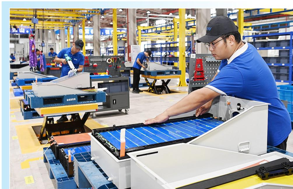
9月6日上午，在江苏益佳通新能源科技有限公司PACK项目生产车间蓝膜包覆生产线上，一个个电芯经蓝膜包覆后，将进行多道工序最后组装成液冷储能一体柜。益佳通公司位于建湖高新区，该液冷储能一体柜采用的是公司自主研发生产的磷酸铁锂“短刀王”电芯，日产量可达50台，主要销往长三角及广东等地。
