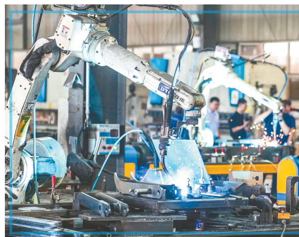
8月26日，位于建湖的盐城可理斯机械制造有限公司生产车间内，自动堆焊设备不停运转。该公司专业从事农业机械和石油机械制造、销售、研发，可年产2500吨精铸产品和8万套万向总成产品。记者 王亚洲 王焱摄
