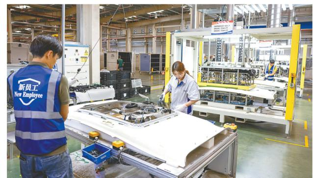
东风延锋盐城汽车座舱系统有限公司位于盐城经济技术开发区，主要从事汽车门板、通道、顶棚等汽车内饰件的研发、生产和销售，是悦达起亚的一级配套商。图为工人正在制作汽车顶棚。 记者 单丹 摄
