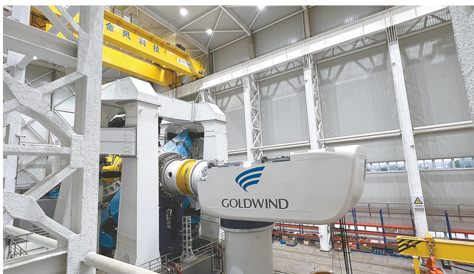
金风科技六自由度机舱传动实验平台。(受访单位提供)
