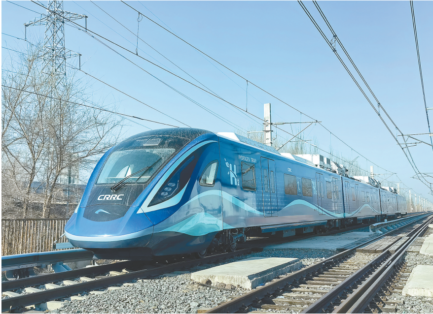
我国首列氢能市域列车在位于长春的中车长客试验线进行运行试验(2024年3月21日摄)。
