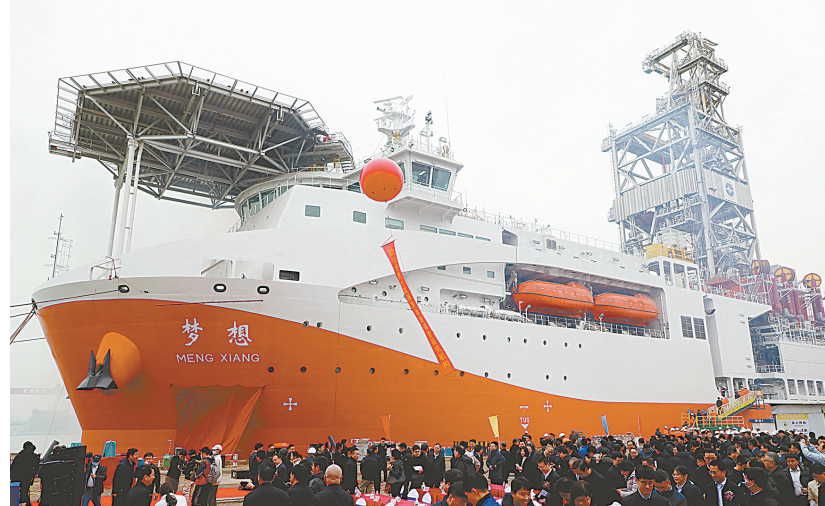
这是12月18日在广州拍摄的命名仪式现场。当日,我国自主设计建造的首艘大洋钻探船正式命名为“梦想”号,并在广州南沙首次试航。大洋钻探被誉为海洋科技“皇冠”。“梦想”号由自然资源部中国地质调查局与150余家单位密切协同建造,总吨约33000吨,续航力15000海里,自持力120天,具备全球海域无限航区作业和海域11000米钻探能力。新华社记者 黄国保 摄
