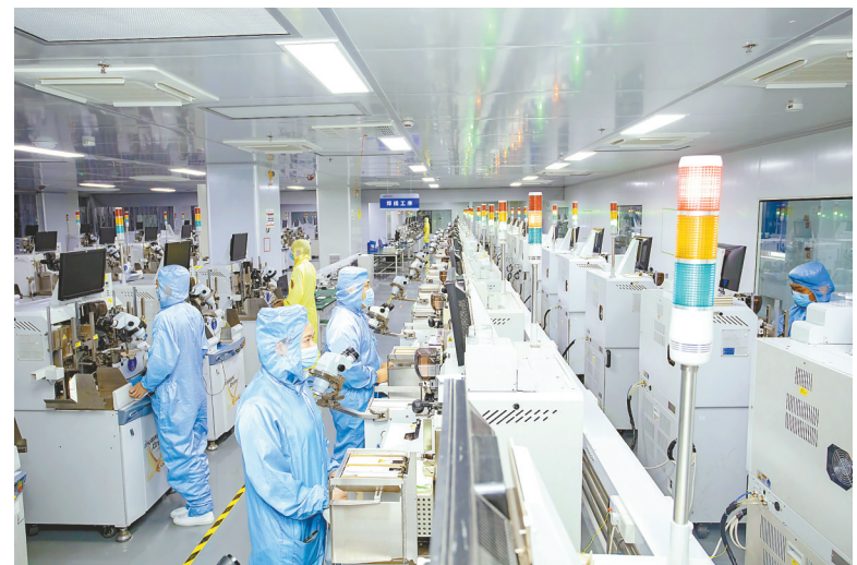
滨海电子信息产业园的江苏正其心半导体有限公司，工作人员正在进行焊线工序。该公司年可生产200亿支超小型无引脚分立器件和集成电路，同苹果、华为、三星、比亚迪汽车等国内外知名厂商均有合作。目前，该公司正组织员工加班加点赶制一批发往深圳的订单，全力确保完成序时目标任务。吴贵民 记者 单丹 摄
