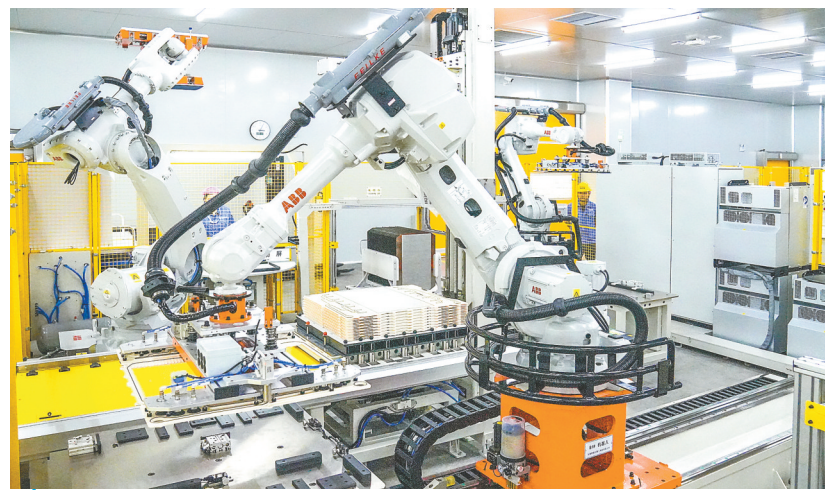
作为一家致力于新型储能技术研发和液流电池智能制造的公司，今年，绿景储能盐城的智能制造工厂正式启用了国内首条百兆瓦级的液流电池电堆智能产线。图为智能机器人在进行液流电池电堆总装堆叠作业。 记者 王焱 摄
