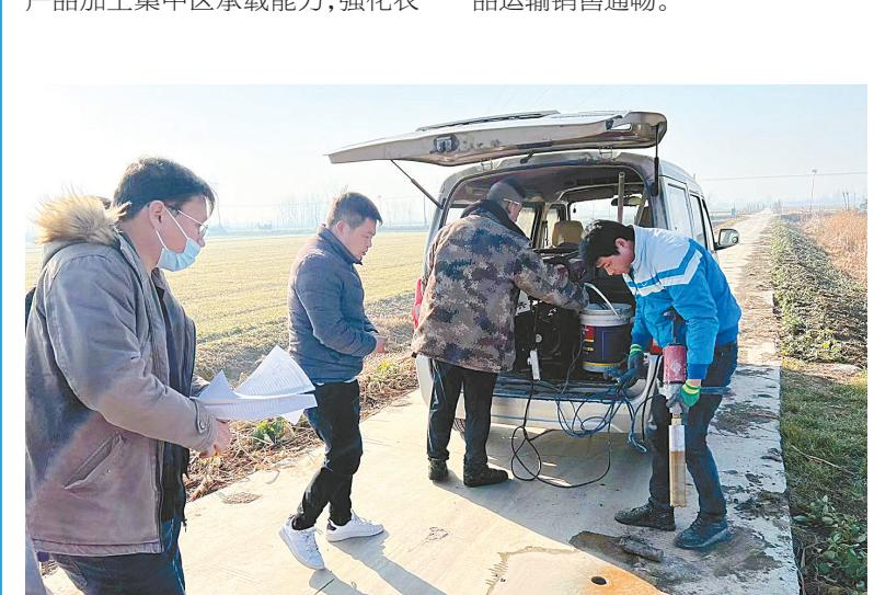
4月20日,阜宁县审计局对农村公路提档升级工程建设项目建设进行审计调查。审计组采用取芯采样和现场测量相结合的方式,全面复核农村公路路面长度、宽度和厚度,进一步规范农村公路建设管理。邓远民 邢潇 摄
