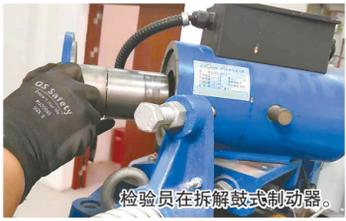
检验员在拆解鼓式制动器。
