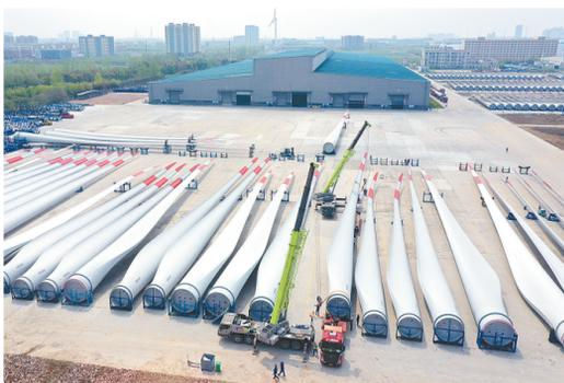
4月19日，在大丰经济开发区江苏双瑞风电叶片生产场地上，工人正在将自主研制的10兆瓦海上风电叶片吊装上车，运送给海上装机用户，努力实现疫情防控、企业发展双胜利。 通讯员 周吉凯 记者 王焱 摄
