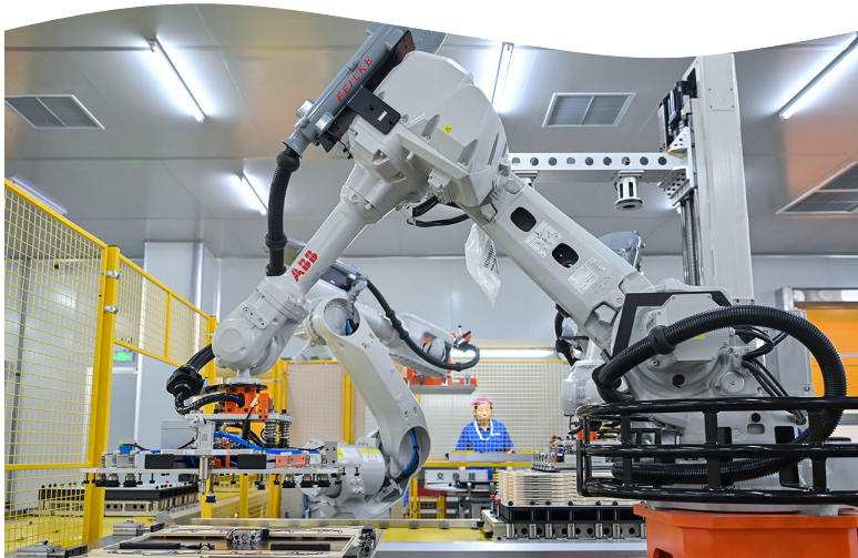
智能机器人在纬景储能盐城智造基地生产车间进行锌铁液流电池电堆总装堆叠作业。
