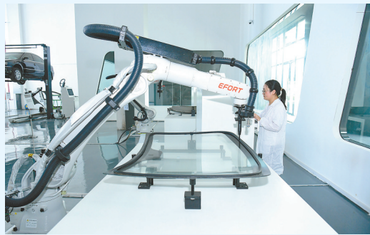
鸿运摇橹船(盐城)信息科技有限公司生产车间里,技术人员进行3D曲面高反光表面检测。
