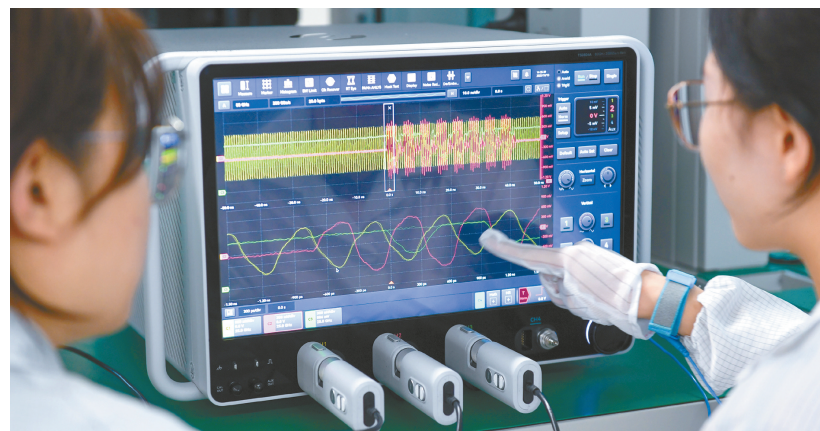
10月13日,在深圳市万里眼技术有限公司,实验室人员在测试DDR5接口信号。
