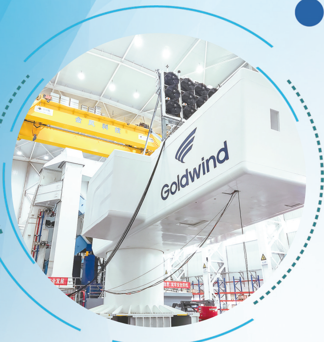
金风科技六自由度16兆瓦整机传动实验平台
