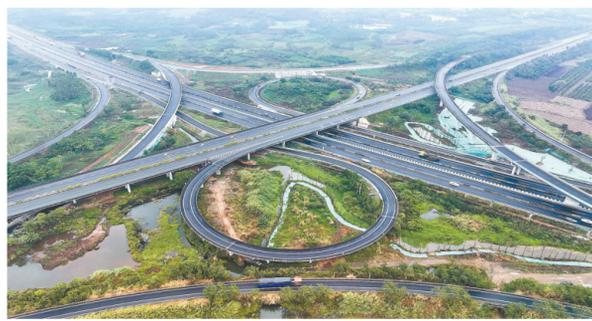
目前,中铁十一局承建的沈海国家高速茂港段改扩建工程临近收官。该项目位于雷州半岛,起于广东茂名市电白区,终于广东湛江市麻章区,全长约108.6公里。全线采用沿旧路两侧拼接加宽将原双向4车道扩建为双向8车道,将大幅提升路段通行能力,保障春运畅通。近期建成通车的东坡岭枢纽位于湛江市遂溪县,是沈海和兰海两条国家高速公路的交汇点(无人机照片,1月23日摄)。新华社记者 刘大伟 摄
